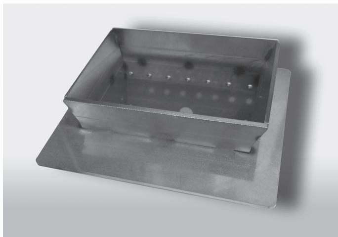
della vostra termostufa a pellet. Nel posizionare il crogiuolo, verificare accuratamente che i bordi dello stesso aderiscano completamente alla loro sede e che il foro coincida con il tubo dedicato al passaggio della resistenza. Non deve esserci nessun residuo di combustione nella zona di contatto tra i bordi del crogiuolo ed il piano di appoggio sul portacrogiuolo.
