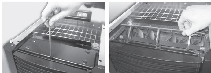
è possibile effettuare la pulizia dopo aver tolto le molle inserite in ogni tubazione. L'operazione è semplice sfilando le molle dal perno orizzontale a cui sono fissate.
