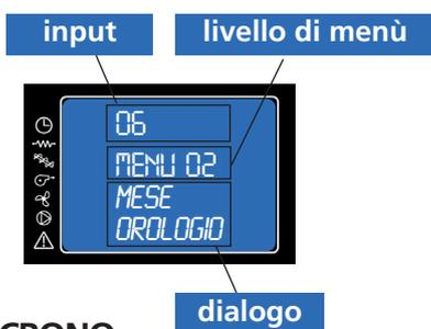
Imposta l'ora e la data corrente. La scheda è provvista di una batteria litio che permette all'orologio interno un'autonomia superiore ai 3/5 anni.
